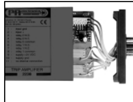
Figure 2. Vous pouvez maintenant extraire la face arrière du module ainsi que la carte à circuits imprimés. Veuillez repérer la position de cette carte car il existe de nombreuses positions possibles dans le boîtier. Lorsque vous extrayez la carte à circuits imprimés, tirez sur celle-ci et évitez de tirer sur les fils. Vous pouvez maintenant déplacer les commutateurs et les cavaliers. Lorsque vous assemblez la face arrière du module et le boîtier, veuillez vérifier que les fils ne sont pas coincés.
