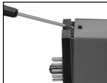
Abbildung 1. Die hintere Abdeckplatte des Moduls wird vom Gehäuse mit Hilfe eines Schraubendrehers gelöst.
